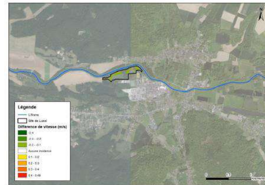
Figure 40 - Différence de vitesse entre l'EA avec mesures compensatoires et l'EI
