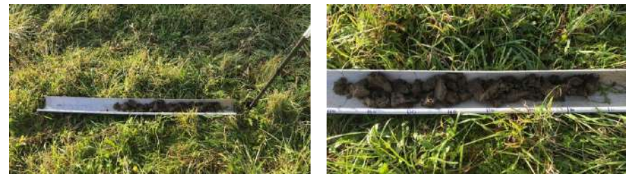
Sur le carottage du point 5, aucune trace d'oxydoréduction jusqu'à 50 cm.
