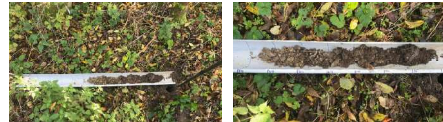
Sur le carottage du point 7, aucune trace d'oxydoréduction jusqu'à 50 cm.
