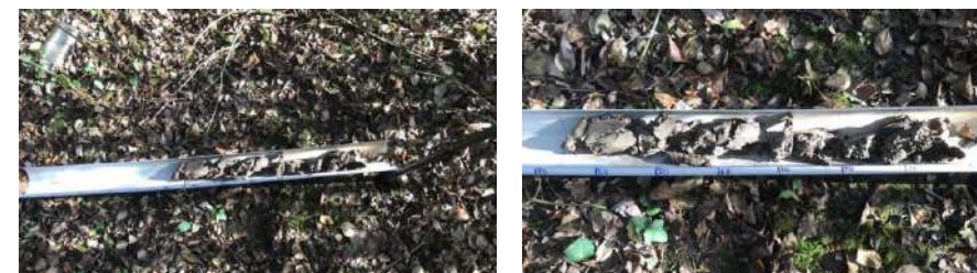
Sur le carottage du point 19, aucune trace d'oxydoréduction jusqu'à 50 cm.
