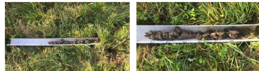
Sur le carottage du point 9, aucune trace d'oxydoréduction jusqu'à 50 cm.
