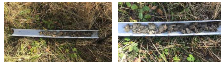
Sur le carottage du point 20, aucune trace d'oxydoréduction jusqu'à 50 cm.
