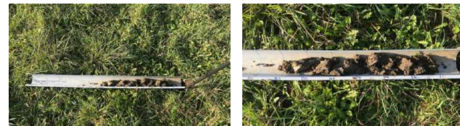
Sur le carottage du point 8, aucune trace d'oxydoréduction jusqu'à 50 cm.
