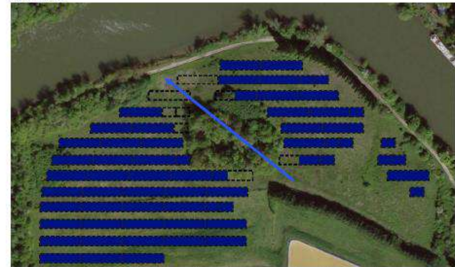
Figure 32 – Panneaux à supprimer pour favoriser l'écoulement
