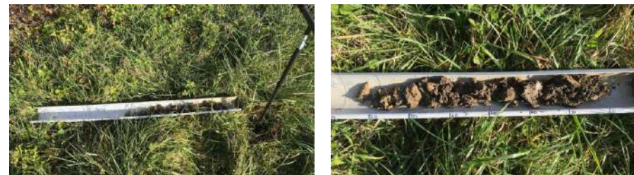
Sur le carottage du point 6, aucune trace d'oxydoréduction jusqu'à 50 cm.
